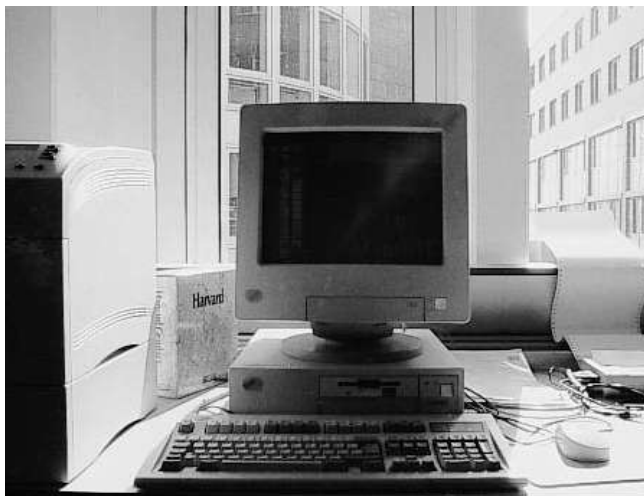
Figura 6 - Posto di lavoro al videoterminale con condizioni di luce sfavorevoli: eccessivo contrasto di chiaro-scuro fra lo schermo e lo sfondo
